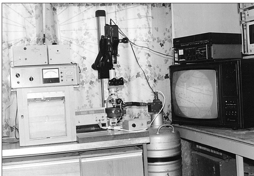
Рис.8. Общий вид установки для исследования микропроцессов в промерзающих образцах.
